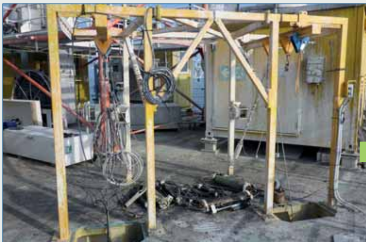
Die zur halbjährlichen Wartung geborgene ozeanographische Messkette des IOW auf der Ostseeplattform FINO 2 / The oceanographic measuring chain of the IOW on the Baltic Sea platform FINO 2 recovered for half-yearly maintenance. (Foto / Source: M. Kaiser, DNVGL)
