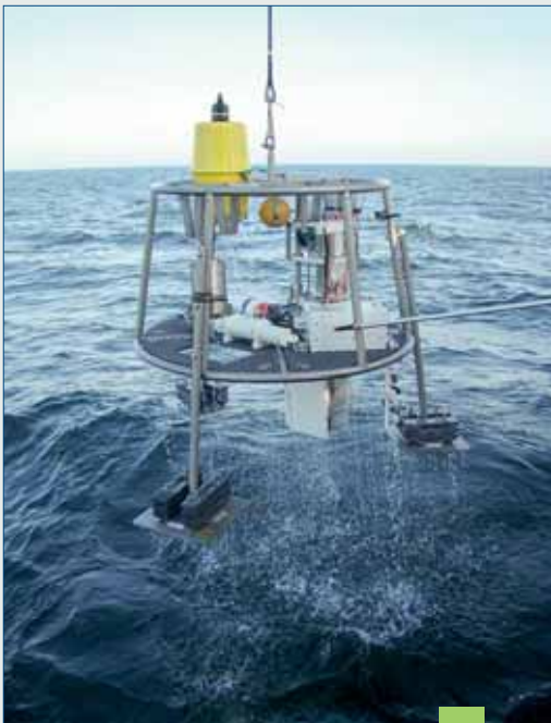
„Warnemuende Benthic Observation Chamber Lander – WaBOB“, ein neuer Lander mit benthischer Kammer im Einsatz auf der EMB 180. / ‘Warnemuende Benthic Observation Chamber Lander – WaBOB’, a new lander with a benthic chamber deployed at the EMB 180 cruise. (Foto / Source: J. Wölfel, IOW)
