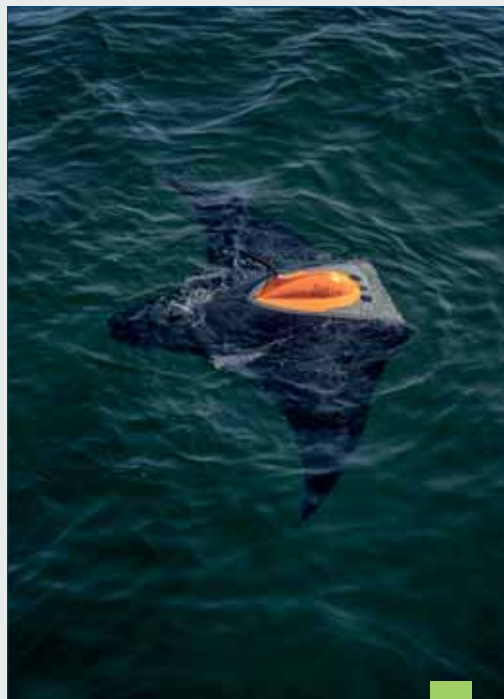
Das autonome Unterwasserfahrzeug (AUV) Manta kurz vor dem Abtauchen an der Wasseroberfläche. / The autonomous underwater vehicle (AUV) Manta at the surface shortly before diving. (Foto / Source: R. Prien, IOW)
