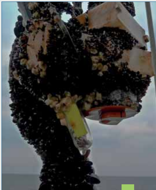
Abb. 1: FLNTU nach 2 Monaten Einsatzzeit mit UV-Foulingschutz / Fig. 1: FLNTU after 2 months in water with a prototype of the UV light source (Foto / Source: M. Sommer, IOW)
